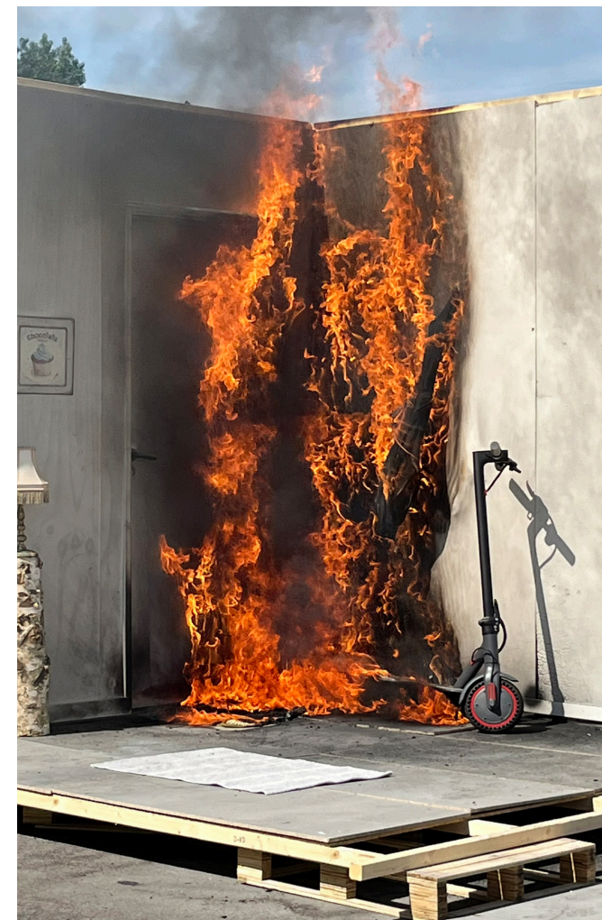
Simulering av batteribrand
