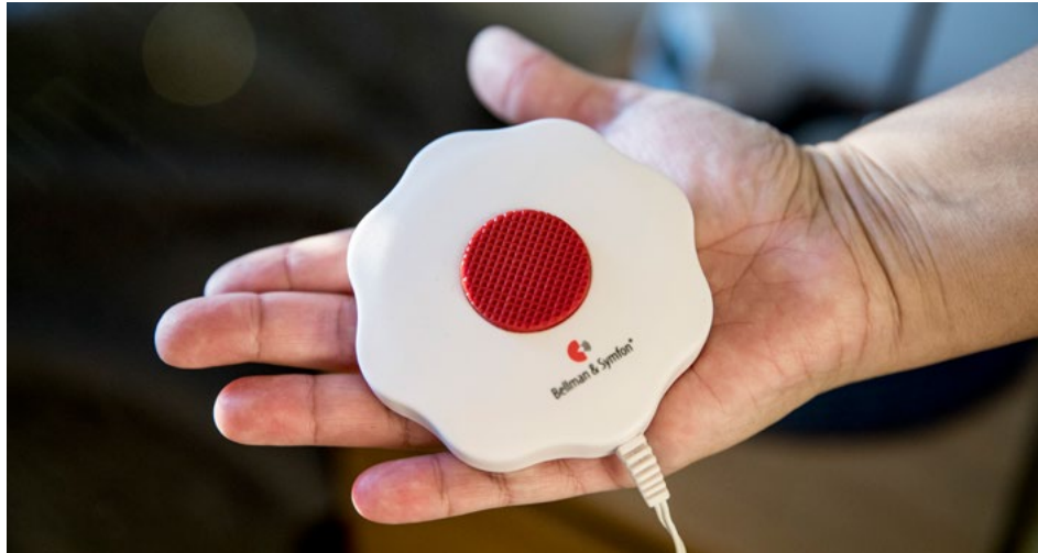
En så kallad kuddvibrator som kan varna vid brand. Foto: Pavel Koubek.
