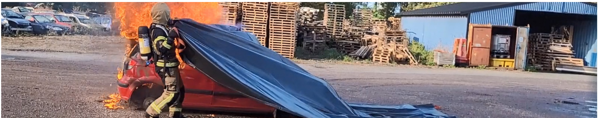
Övning med bilbrandfilten som togs i bruk under året. Användandet av denna pausades i slutet av året då den vid enstaka tillfällen inte fungerat tillfredsställande.
